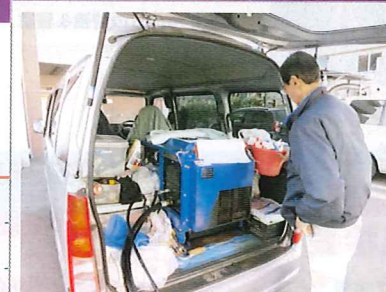
高圧洗浄機。1平方センチメートルあたり150kg以上の水圧を出すことができます
