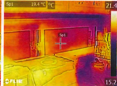
■キッチン：インナーサッシ閉めるとインナーサッシガラス温度19.4°C
